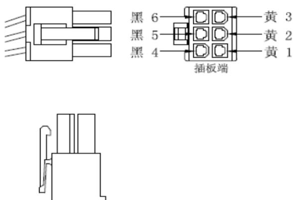
PCIE 输出线由两种颜色线组成，12V 正极线为黄色，负极线为黑色。
