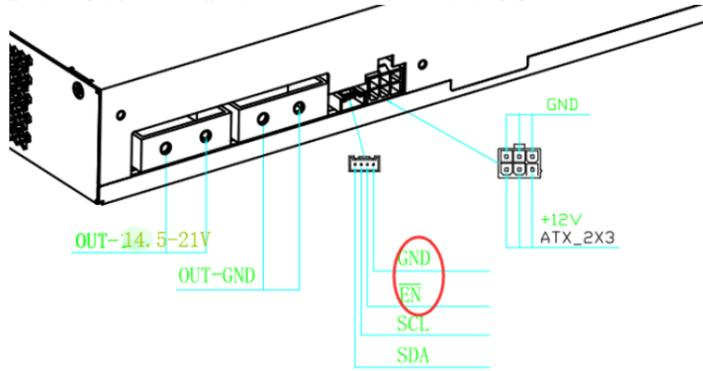
2.4 有条件的可用控制板 V1.2 与 APW9 电源 PIC 端口连接测试图，标示 1 为专用卡测试固件，2 为 DC 电压调试高低转换按键，3 为 PIC 通讯端口，4 为控制板信插座，5 为 12V 供电；注意黄正黑负。说明：一般电源不良品维修好后，上电只需短接 PIC 通讯 J15 端口 EN-GND 脚，就有电压输出 21V 左右为正常，就可以不用以下控制板单独测试（当 PIC 单片机坏，或固件异常重新烧录后需小板测试），可直接装相应的矿机测试。
