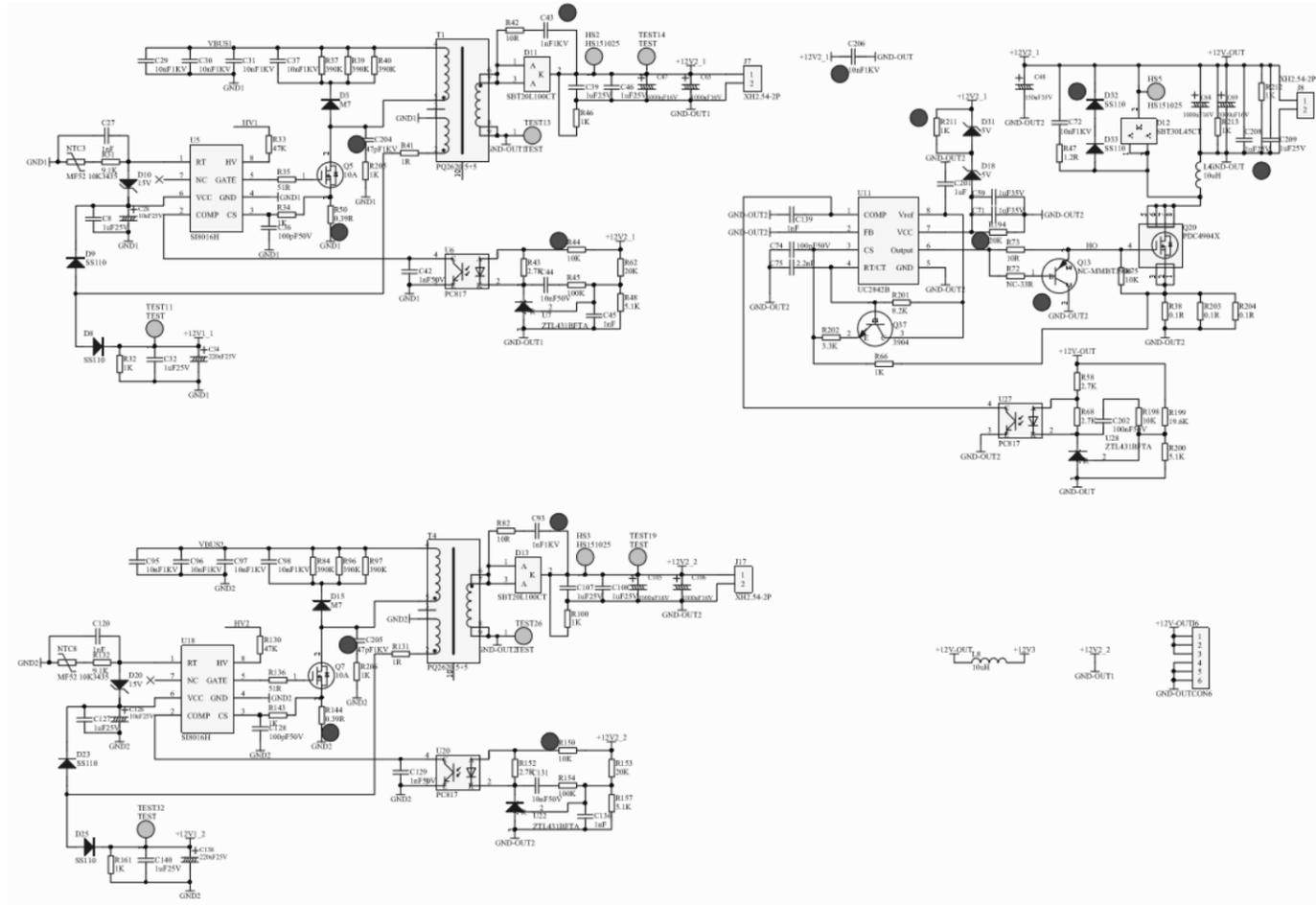
主 PWM 芯片 U9 VCC 供电控制，注意前端两路 PFC 需工作正常。
