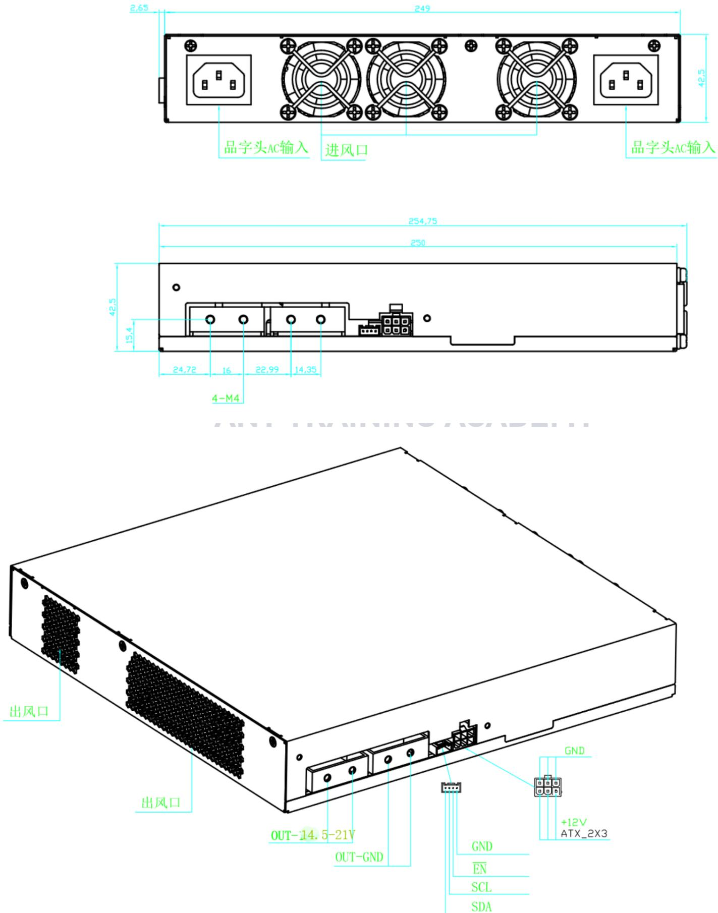
说明：如需要开机默认电压 21.32V 测试，可用转接线对调压端口 Pin 针 EN 与 GND 短接。
