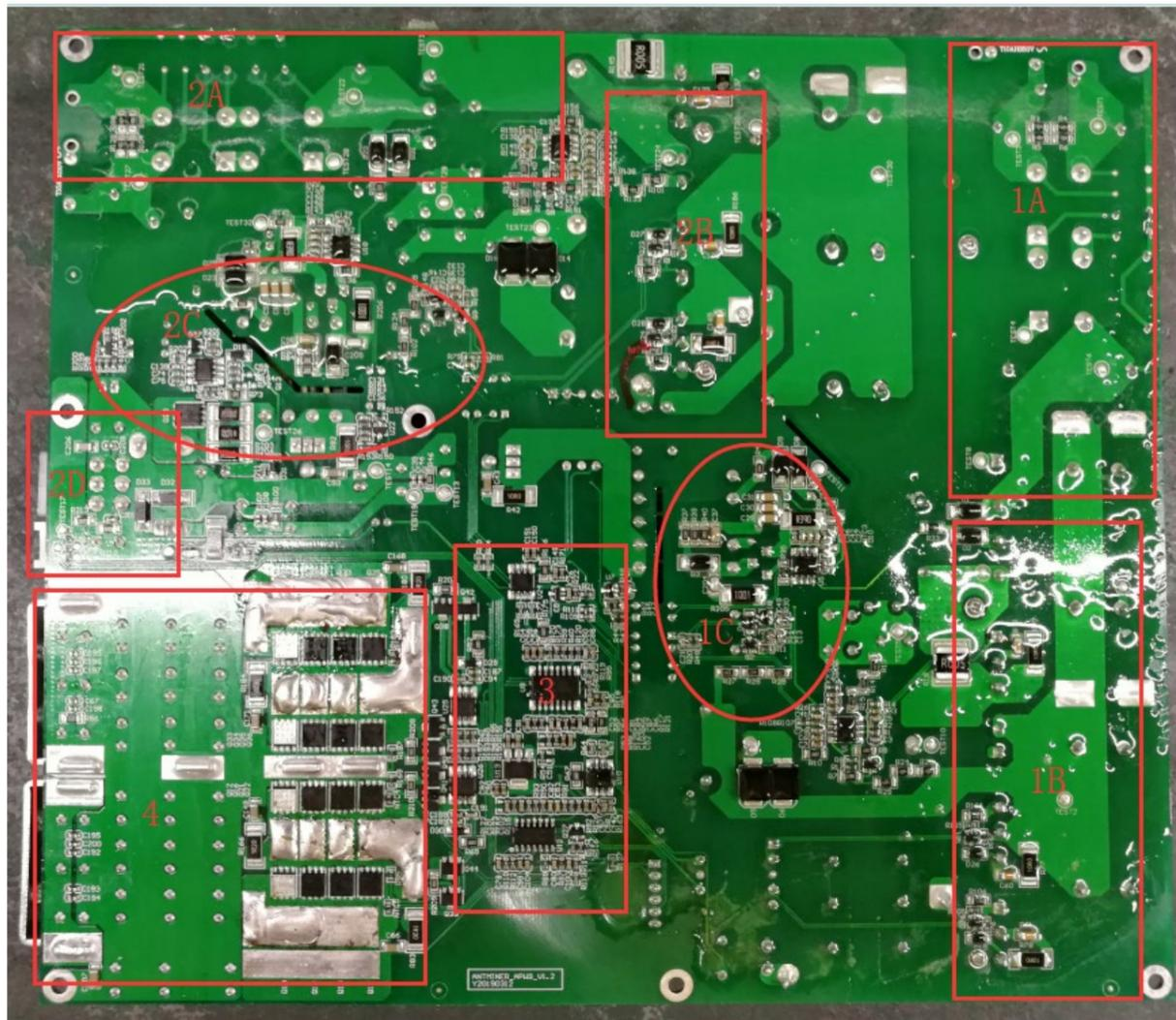
布局标示说明：1A——第一路 AC 输入及 EMI 电路， 1B——PFC 及主并关 MOS 电路， 1C——12V 辅助及 VCC 电路。
