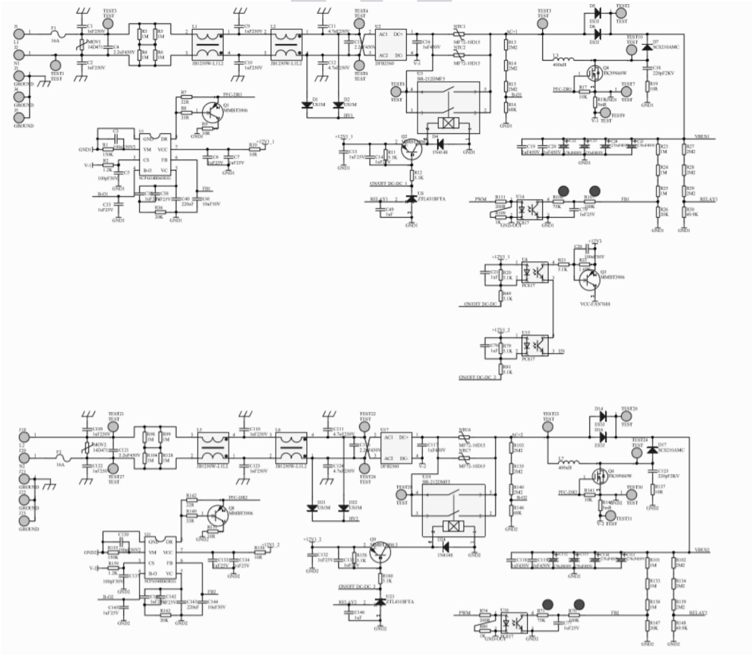
2.22 两路 12V 辅助电路及风扇供电原理，如 12V 1 路重点先量测电压检测启动电阻 R33,47K 以及与 HV 相接至 D1,D2 是相通的，F3,Q5,D8,D9,T1 是否有损坏等（另一路检查方法一样）。12V 输出，以下电路是由前端两路 12V 串联最终控制转换至输出端+12V 供矿机控制板。
